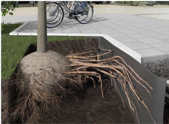
Abbildung 14: Punktueller Wurzelschutz Quelle: GEFA Produkte® Fabritz GmbH, 2024 35
